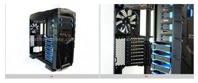
Nella parte posteriore del telaio possiamo vedere la ventola in estrazione da 120mm, al di sotto della quale troviamo la serie di bracket PCI, ognuno dei quali è fissato in sede da una vite zigrinata utile per un'installazione tool-less delle schede.
