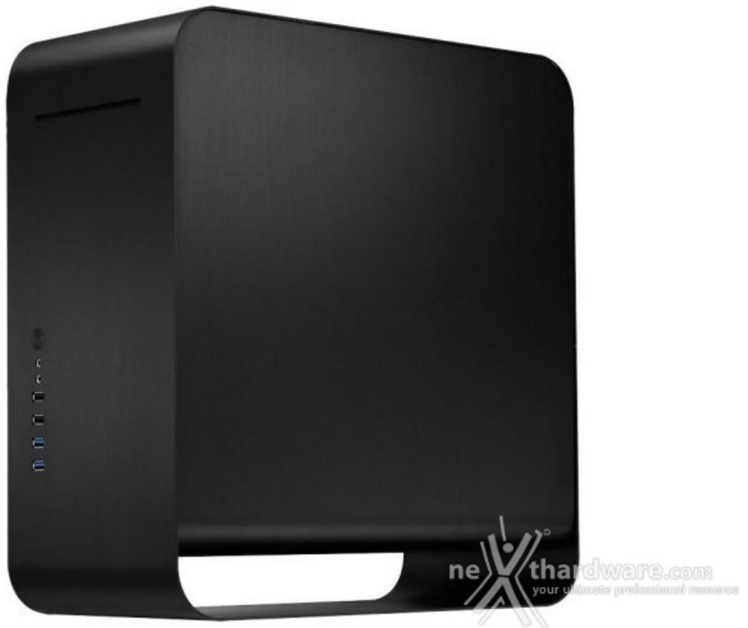
Tale scelta non è dettata solo da un'esigenza estetica, ma come visibile dalle immagini, si è resa necessaria in quanto il sistema di raffreddamento interno prevede due ventole da 120mm (in immissione) poste sulla parte inferiore del case.
