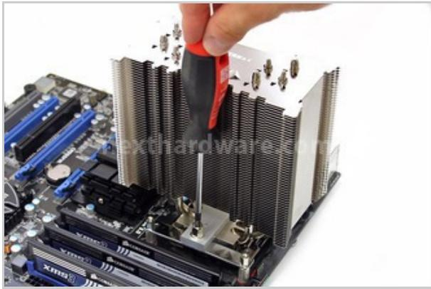
Avvitiamo i due dadi con l'ausilio di un cacciavite.
