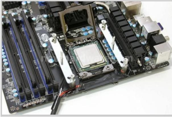
Come possiamo vedere la gabbietta di ritenzione si apre alla perfezione ed è possibile sostituire facilmente la CPU.
