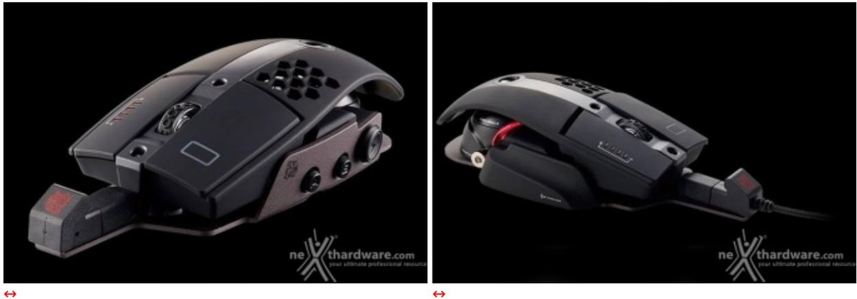
La tecnologia utilizzata per il collegamento via etere è di tipo Wi-Fi 5.8G, molto ricercata in gaming perché, contrariamente alla 2.4G, è molto meno soggetta ad interferenze e disturbi provenienti da altri dispositivi.
