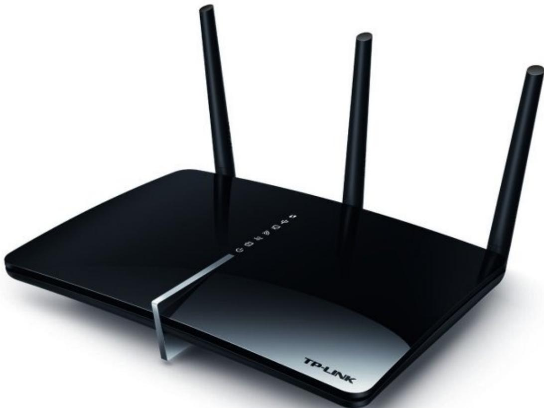
La doppia banda (2,4 e 5GHz) diminuisce la possibilità di interferenze tra i vari dispositivi connessi e, grazie anche alle tre antenne esterne, in abbinamento ad altrettante interne, riesce ad assicurare una migliore copertura del segnale wireless.
