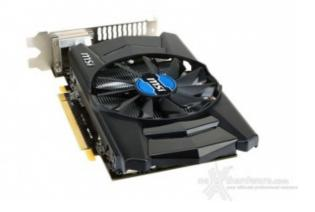
La velocità della ventola, oltre ad essere regolata automaticamente in base alle temperature d'esercizio della GPU, può essere modificata manualmente usufruendo del noto software MSI Afterburner.
