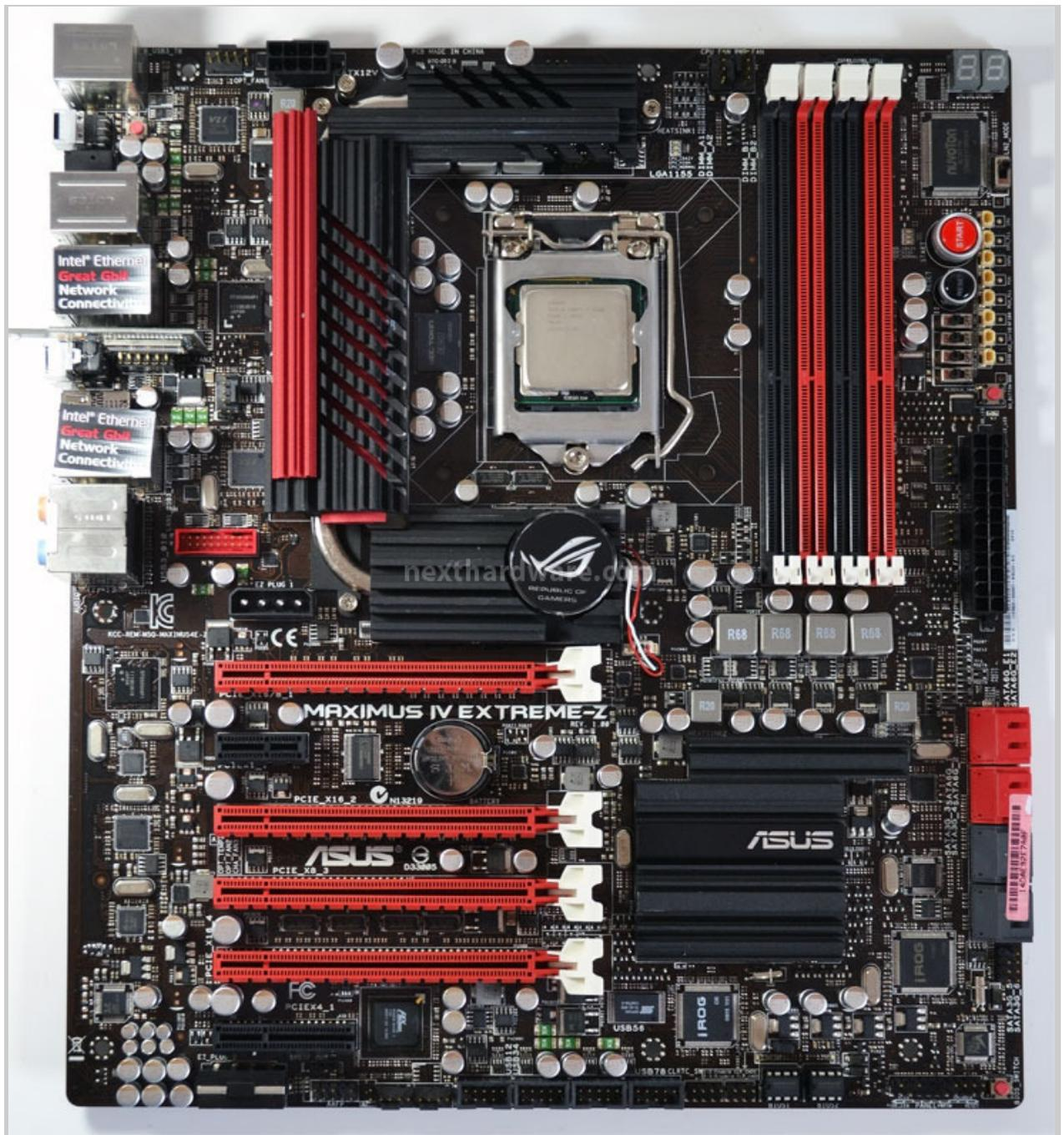
La Maximus IV Extreme-Z è basata sul Platform Controller HUB Intel Z68 e socket 1155 per CPU Intel Sandy Bridge ed ospita un bridge NVIDIA NF200 per supportare al meglio le configurazioni 3-Way SLI e CrossFireX.
