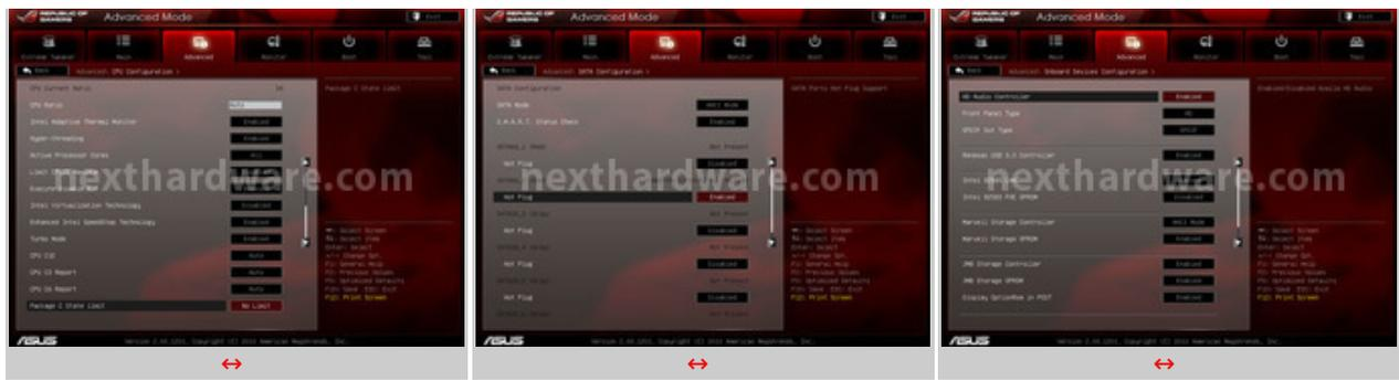
Tutti i controller presenti sono disattivabili singolarmente per migliorare i tempi di Boot o per evitare la configurazione di periferiche che a priori sappiamo già di non voler utilizzare.
