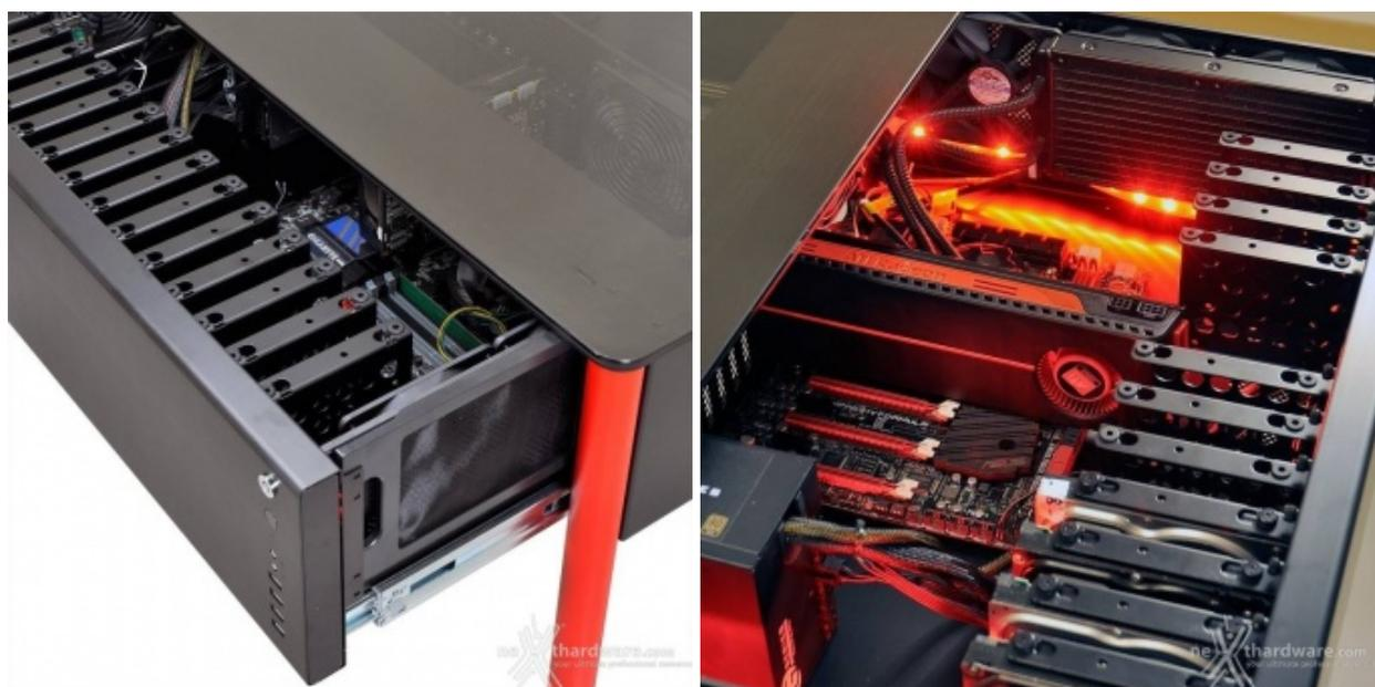
L'elevato spazio a disposizione permette l'installazione di qualsiasi scheda video attualmente sul mercato, anche in SLI o Crossfire, e il tutto potrà essere raffreddato anche a liquido usufruendo delle predisposizioni per ventole da 120mm.
