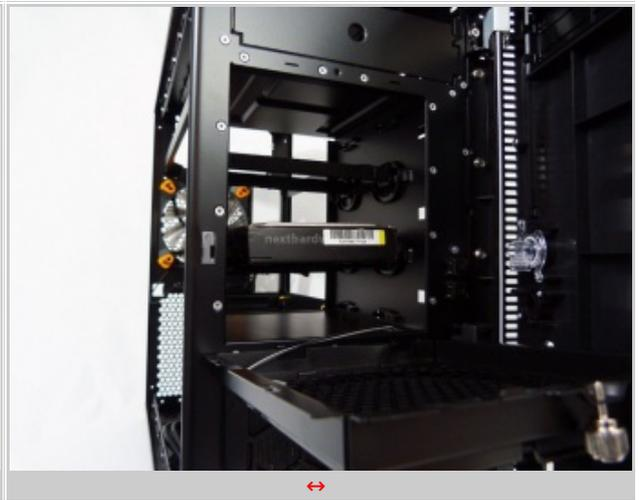
Dietro al filtro superiore troviamo un sistema brevettato da Antec, composto da due coppie di elastici che vanno ad avvolgere e stringere i dischi alle estremità per un'installazione rapida e priva di vibrazioni.
