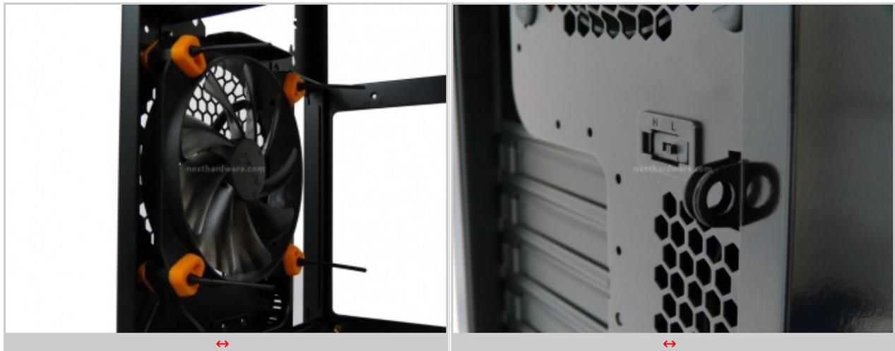
Poco più in basso possiamo trovare una ventola da 120mm con accanto il vano per l'I/O Shield della scheda madre, i bracket delle PCI ed una superficie forata, sempre a nido d'ape, per favorire il ricircolo dell'aria con le schede installate↔ .
