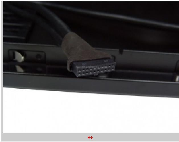
Dettaglio del cavo di connessione USB 3.0
