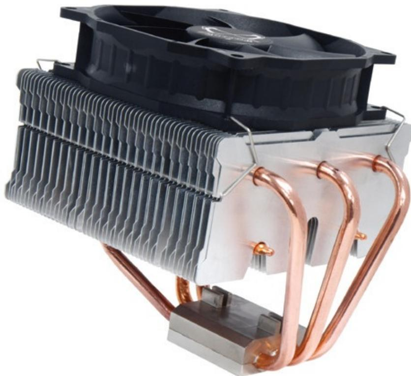
Lo Scythe Scior-1000 ha il corpo dissipante realizzato in alette di alluminio che si sviluppa in orizzontale anziché in verticale, come invece avviene sulla stragrande maggioranza dei dissipatori.
