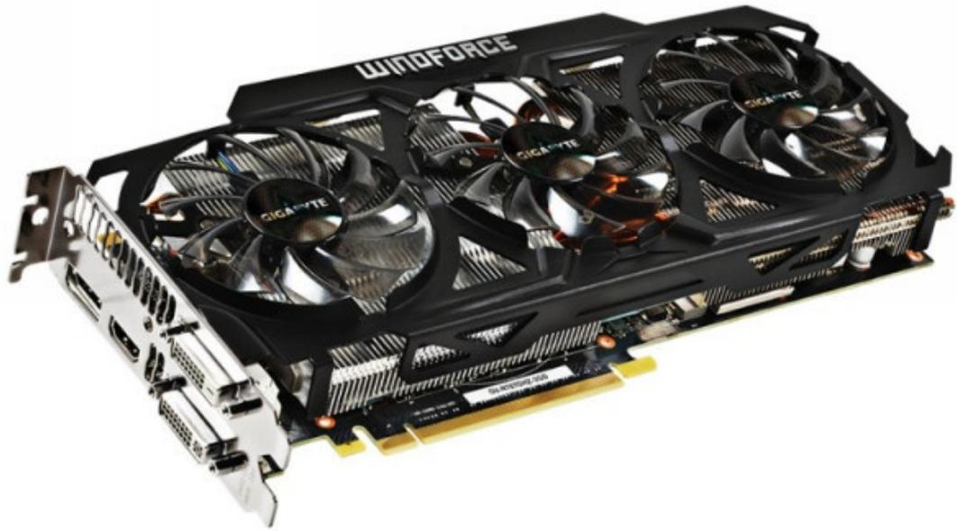
Il nuovo modello di punta fra le schede grafiche equipaggiate con GPU GK110 presenta un design a 8 fasi di alimentazione ed un dispositivo di raffreddamento WindForce 3X, in grado di dissipare fino a 450W grazie alle tre ventole presenti (due da 80mm e una da 60mm) e alle sei efficienti heatpipes in rame.
