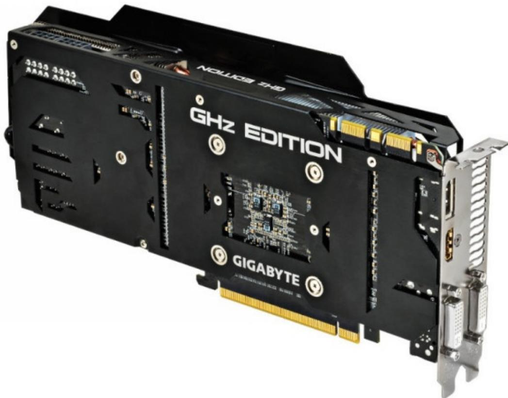
La scheda prevede inoltre un backplate in metallo che, oltre a rinforzare la struttura, facilita il raffreddamento della componentistica che si trova sul retro del PCB.
