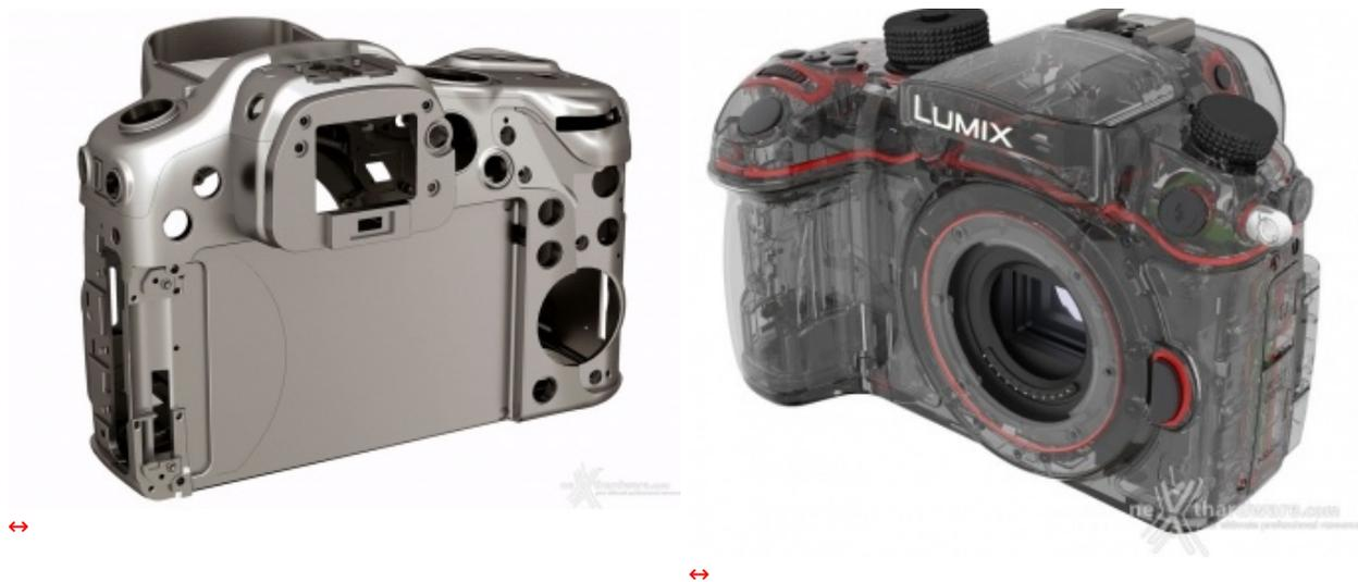
La **Panasonic GH4** ha un corpo tropicalizzato in lega di magnesio, al suo interno troviamo il nuovo sensore **CMOS** da **16 megapixel** unito al processore d'immagine quad-core **Venus Engine IX** che consentono di girare video **4K** e **1080p** con bitrate massimo di **200Mbps**, **12fps** di scatto continuo fotografico ed una gamma **ISO 200-25600**.
