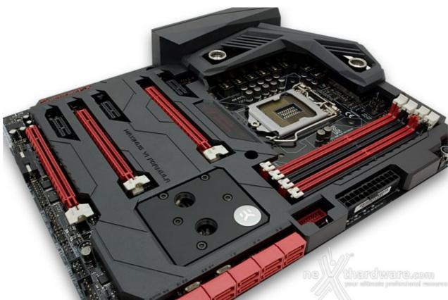
I waterblock che compongono questo kit vanno a raffreddare direttamente il PCH (Platform Controller HUB), VRM e Mosfet.
