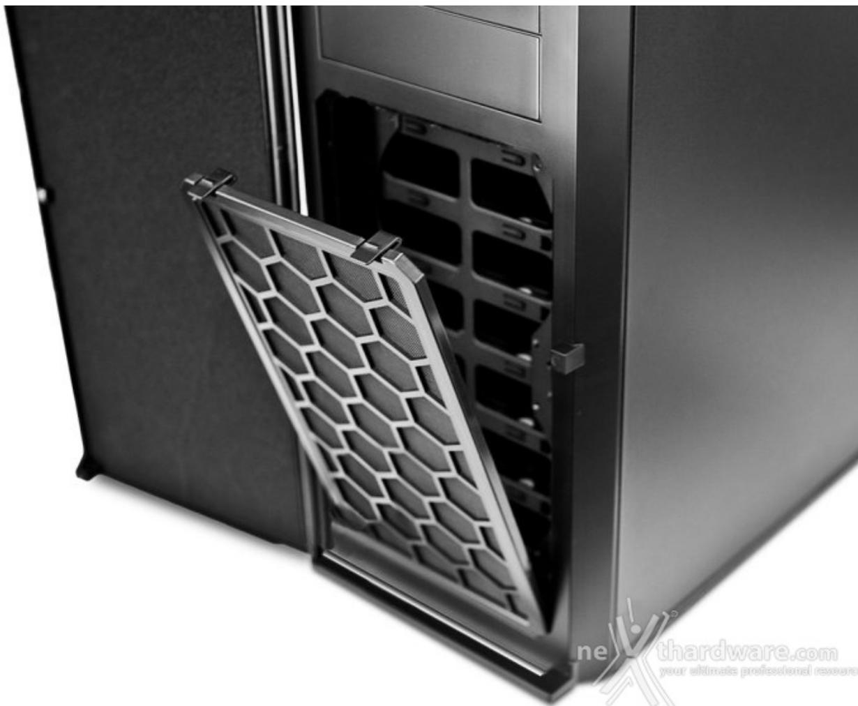
Sia il frontale che il vano alimentatore sono protetti da robusti filtri antipolvere facilmente removibili e lavabili sotto acqua corrente.
