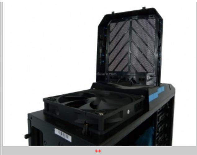
La ventola, a sua volta, può essere facilmente smontata rimuovendo le quattro viti che la fissano allo chassis.
