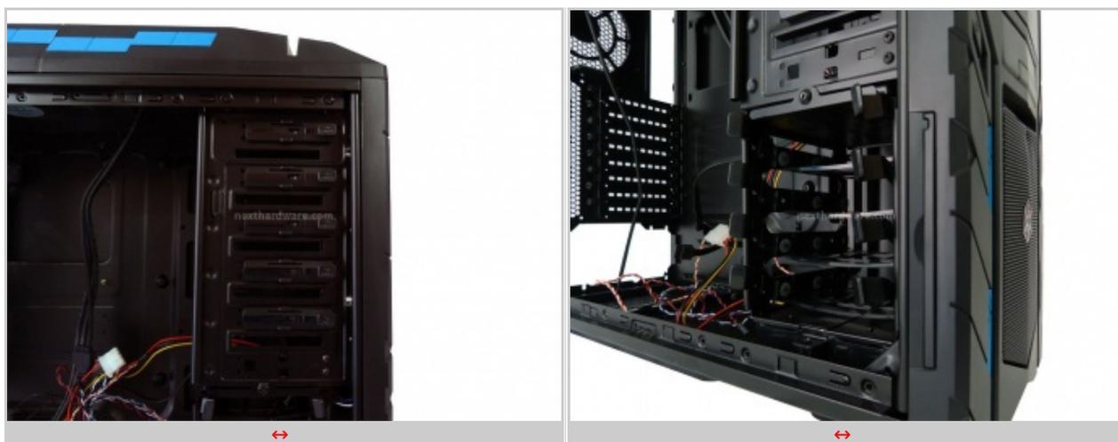
Nella parte superiore del frontale sono posizionati cinque bay da 5.25" nei quali possono essere installati i drive in modalità tool-less tramite la pressione di un fermo che, a sua volta, inserisce un perno di metallo, al posto della classica vite, per bloccare in sede le periferiche.
