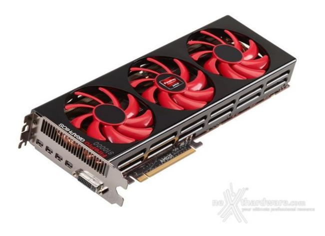
Con pieno supporto al protocollo PCI Express 3.0 e ottimizzata per OpenCL, la AMD FirePro S10000 12GB Edition integra il supporto per le memorie ECC e per la tecnologia DirectGMA (Direct Graphics Memory Access), permettendo così agli sviluppatori di sfruttare in pieno i vantaggi offerti dalle capacità di calcolo parallelo che caratterizzano le GPU di AMD basate sull'architettura Graphics Core Next (GCN).
