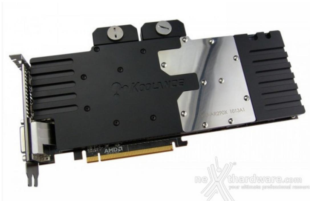
Il waterblock pesa 0,91 kg, ha due attacchi BSPP da G 1/4 e dispone di una canalizzazione interna con design microfin da 0,5 mm ad alte prestazioni.
