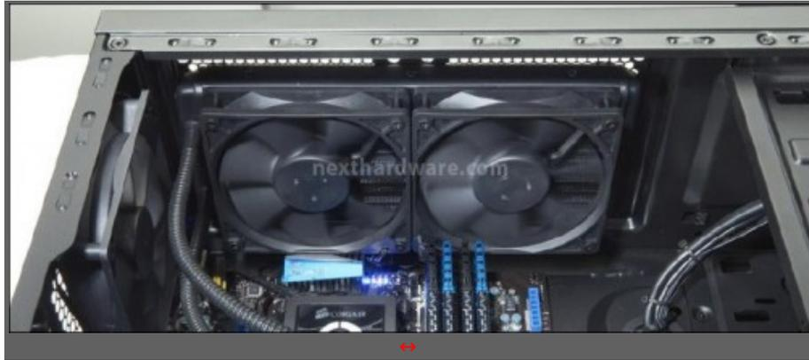
La zona superiore consente anche il montaggio di un radiatore per impianti di raffreddamento a liquido da 240mm; a giudicare però dallo spazio disponibile, supponiamo che il radiatore in questione debba essere di tipo slim (a singola fila di tubi piatti), come quello previsto per il sistema Corsair H100.
