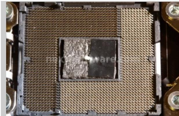
La sonda posizionata sotto alla CPU: la stessa è stata cablata utilizzando un cavo di rame smaltato di piccola sezione, passato al di sotto del socket 1366.
