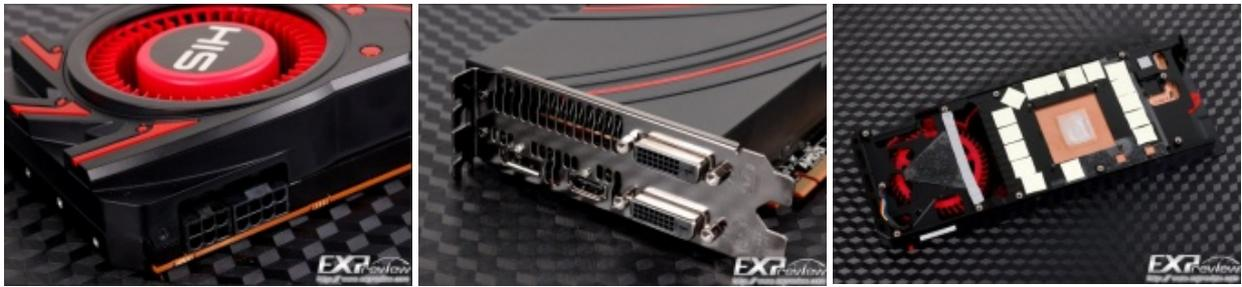
Questa volta si scende nel particolare e, oltre al sistema di raffreddamento, opportunamente smontato, fanno bella mostra di sé il PCB ed i principali componenti su di esso montati, tra cui spicca la sezione di alimentazione a 5+1 fasi, i 16 chip di RAM disposti tutti su un solo lato, e sua maestà Hawaii a 28nm con ben 7,08 miliardi di transistor.
