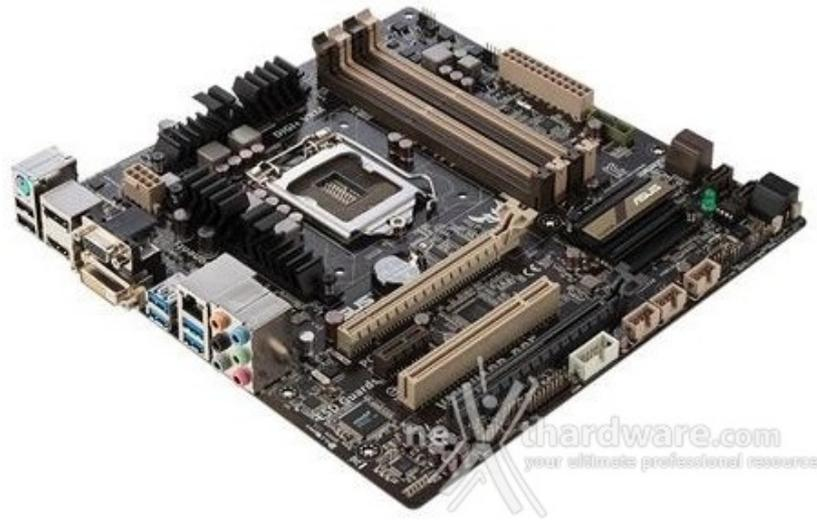
La mainboard dispone di uno slot PCI-Express 3.0 x16, di uno slot PCI-Express 2.0 x4, di uno slot PCI-Express 2.0 x1 e di uno slot PCI legacy.
