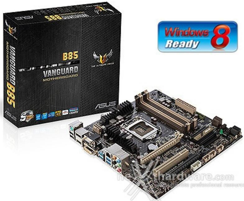
La mainboard utilizza un circuito di alimentazione per la CPU a 4 fasi, realizzato con componentistica di alta qualità e ben raffreddato tramite un efficace sistema di dissipazione.
