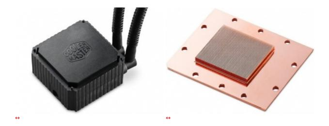
Il gruppo ha la forma di parallelepipedo con misure pari a  $62 \times 62 \times 36,4$  millimetri (LxPxA) e viene bloccato sulla CPU tramite un sistema di ritenzione molto simile nel design a quello utilizzato dal Corsair Hydro H80i.
