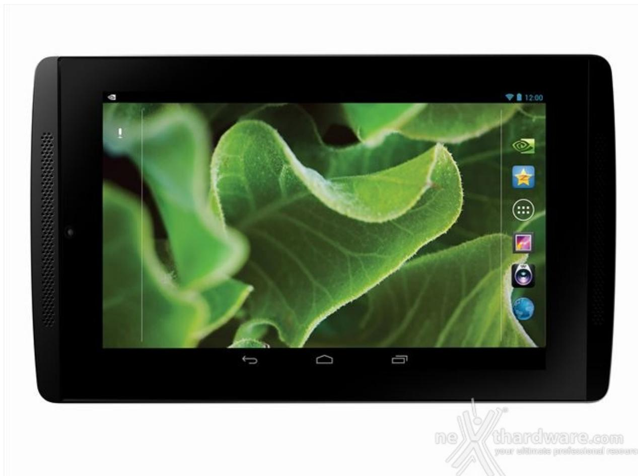
In soli 9,6mm di spessore troviamo uno schermo capacitivo multi-touch da 7" di ottima qualità , costruito con tecnologia IPS e capace di una risoluzione di 1200x800, con cui si può apprezzare le potenzialità offerte dal chip NVIDIA.
