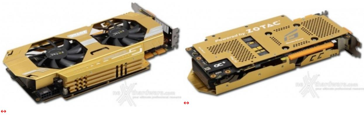
Il sistema di raffreddamento è costituito da una Vapor Chamber, collegata al corpo dissipante realizzato in alette di alluminio tramite una serie di heatpipes in rame.
