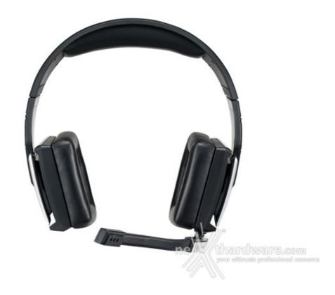
Il microfono è del tipo monodirezionale con funzione di cancellazione del rumore ed è removibile quando non in uso.
