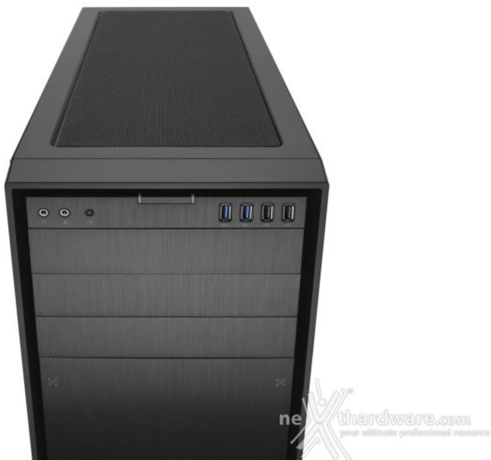
Anche in questo caso la struttura è in solido acciaio con un frontale in alluminio spazzolato che presenta nella parte superiore un pratico I/O Panel, su cui trovano posto due porte USB 3.0, due USB 2.0 e le connessioni per cuffie e microfono.
