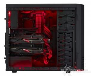
Presenti anche sette alloggiamenti per HDD da 3,5", di cui uno provvisto di un adattatore per un SSD da 2.5", tutti con sistema di installazione tool-less in una gabbia non removibile e perfettamente allineata, rispetto al flusso di aria, per non diminuire l'efficienza delle ventole installate.
