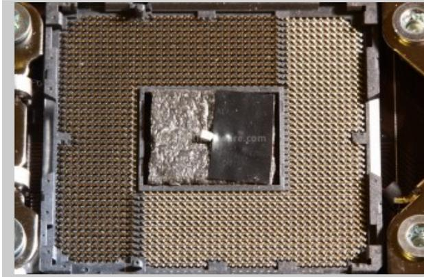
La sonda posizionata sotto alla CPU: la stessa è stata cablata utilizzando un cavo di rame smaltato di piccola sezione, passato al di sotto del socket 1366.
