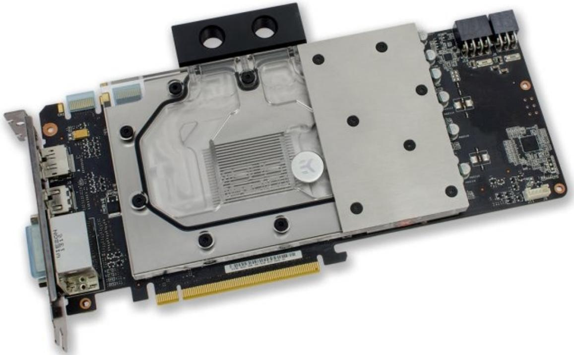
Il design interno prevede, ancora una volta, una canalizzazione abbastanza "aperta" consentendo l'abbinamento dell'EK-FC780 GTX DCII anche con pompe non molto potenti.
