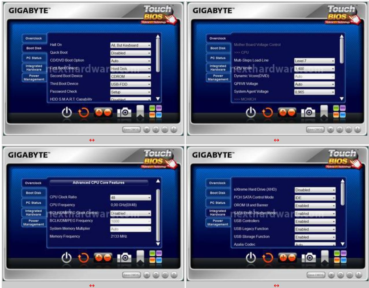
Touch BIOS nasce dallâ€™™ esigenza di fornire agli utilizzatori di sistemi non dotati di tastiera e mouse, ma solo di schermo touch, la possibilità di interagire con le impostazioni del sistema; basti pensare a come potrebbe essere complesso modificare la sequenza di boot su un tablet PC per installare un nuovo sistema operativo.
