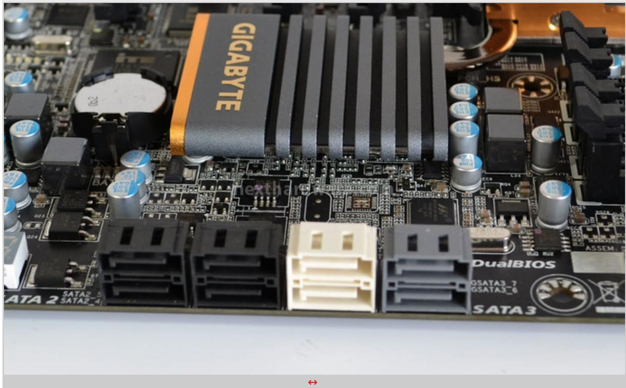
L'Intel Z68 supporta le modalità RAID 0, 1, 4 e 10, utilizzando una combinazione qualsiasi delle sei porte disponibili e la velocità sarà conforme a quella dei dischi collegati alle quattro SATA 2.0.
