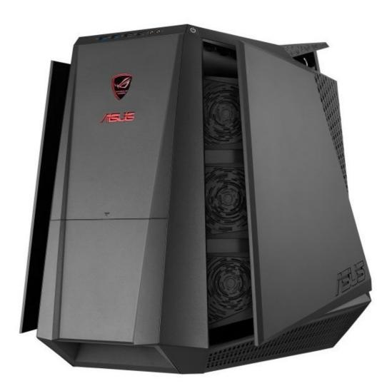
In base all'overclok impostato, il case apre automaticamente alcune prese d'aria poste frontalmente e lateralmente abilitando le ventole a riposo che lavoreranno in abbinamento ad un sistema a liquido integrato per una migliore capacità di raffreddamento del sistema.
