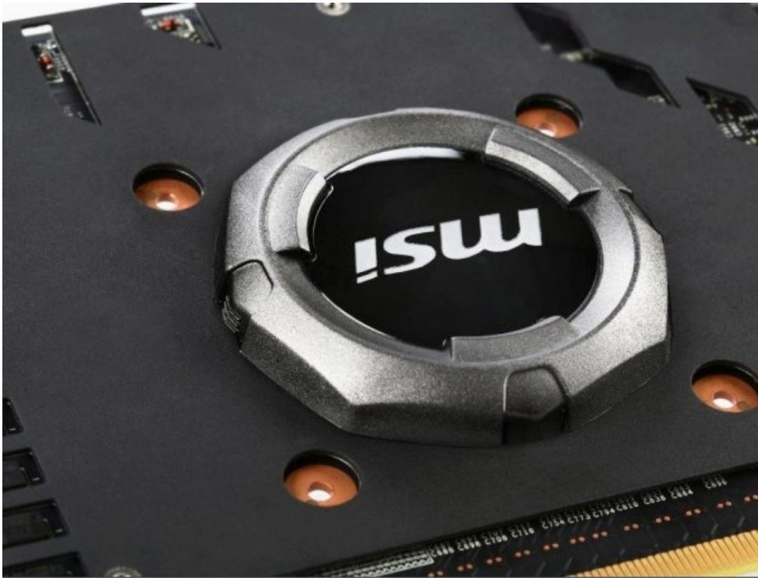
Passiamo ora ad una immagine del famoso modulo denominato GPU Reactor, in grado di pulire il segnale elettrico e di aumentare la tensione erogabile sulla GPU, questa volta della stessa tonalità di colore del dissipatore.
