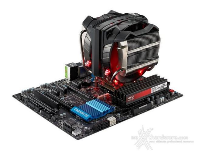
Le dimensioni sono pari a  $154 \times 149.8 \times 166.5$ mm con un peso complessivo di 1074 grammi, nello specifico 854g per il dissipatore e 110g per ognuna delle due ventole da 140mm con cui è equipaggiato.
