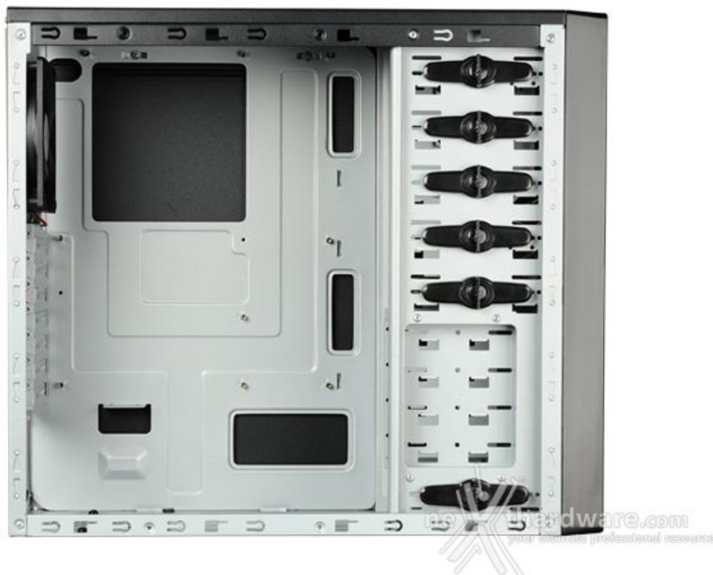
Il nuovo case fornisce la base perfetta per le moderne configurazioni gaming e ufficio: sette slot PCI, quattro alloggiamenti per ODD e sei per HDD consentono futuri aggiornamenti del sistema senza alcuna difficoltà .
