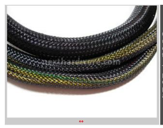
Ottimo lo sleeving che vede, per la prima volta, una maglia composta da 4 fili in PVC a rivestire il cavo ATX 24 Pin, mentre è presente una trama a tre fili su tutte le altre connessioni.
