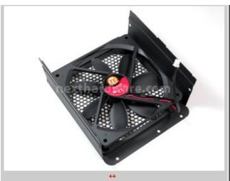
Particolarmente efficaci le scelte adottate per diminuire la rumorosità che consistono nell'utilizzo di una ventola "openframe" con disegno delle pale caratteristico.
