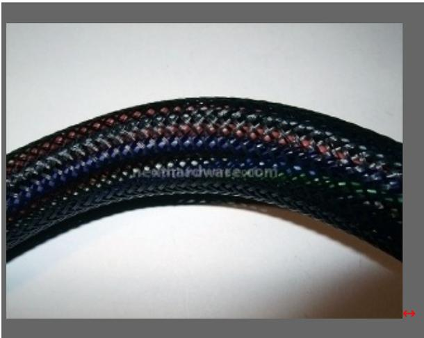
Scelta più importante da parte di Sirtec per il fascio di cavi che alimenta il connettore ATX 24 pin. Soluzione con trama in Nylon multifilo, da sottolineare come durante le fasi di testing il rivestimento sia "escivolato" fuori dal termostringente che dovrebbe assicurarlo al cavo.
