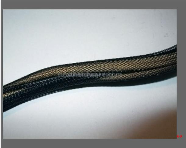
Trama molto semplice utilizzata per la guaina in Nylon che riveste tutti i cavi saldati e modulari. Buono nel complesso il risultato anche se non di grandissimo effetto estetico.
