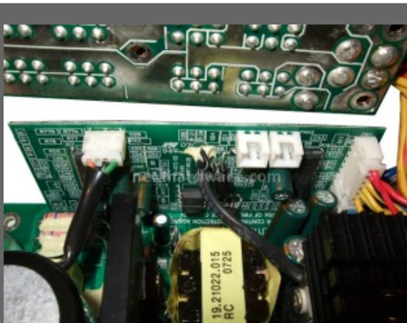
Seconda scheda separata che gestisce regolazione voltaggio e termocontrollo delle ventole.
