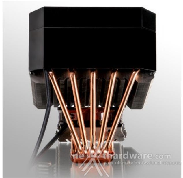
Le cinque heatpipes centrali spingono il calore verso il dissipatore superiore, di maggiori dimensioni, che viene raffreddato da una ventola PWM da 140mm dotata di LED bianchi e avente una velocità di rotazione variabile tra gli 800 ed i 1200 RPM.
