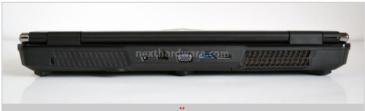
Sul retro sono presenti le uscite video HDMI e VGA, una porta RJ45 per la scheda di rete Gigabit, una connessione eSATA gestita dal PCH Intel HM67 ed il jack per l'alimentatore.
