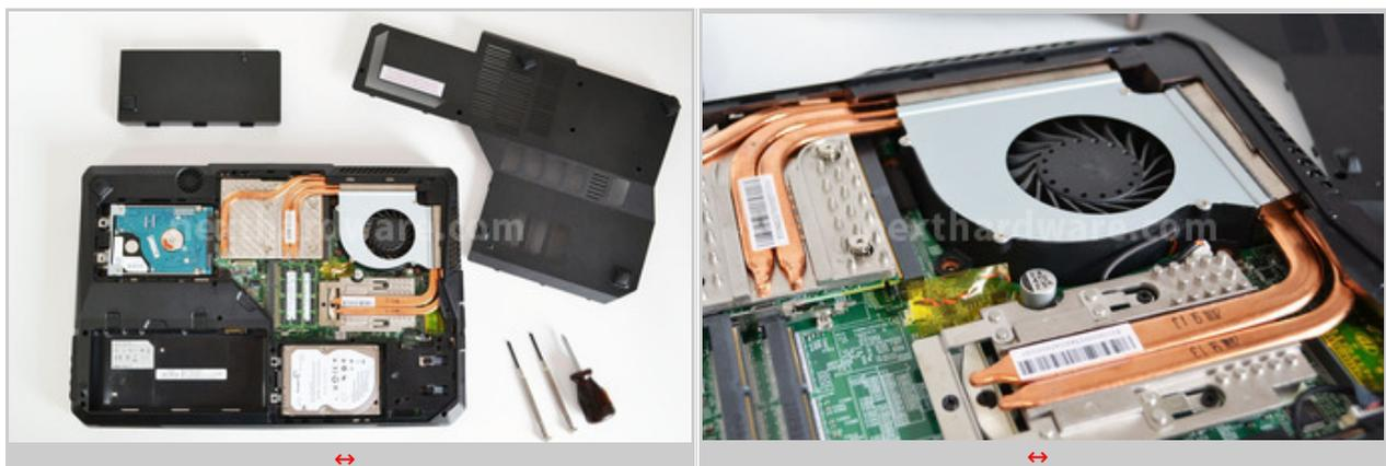
I due Hard Disk sono posizionati ai lati della batteria e possono essere facilmente sostituiti con dischi più capienti o con unità SSD.
