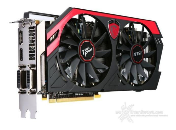
Il raffreddamento è affidato alll'efficiente sistema Twin Frozr IV Advanced che utilizza la tecnologia proprietaria MSI Airflow Control con due ventole over-size da 100mm dotate di speciali pale Propeller Blade.
