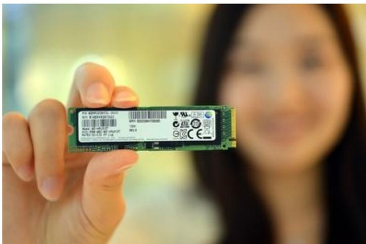
I nuovi Samsung XP941 sono i primi modelli di SSD con un form-factor M.2 (80x22mm) e un peso di soli 6 grammi, perfetti per essere installati in dispositivi mobili ad alte prestazioni e caratterizzati da uno spessore ridottissimo come gli Ultrabook Intel.
