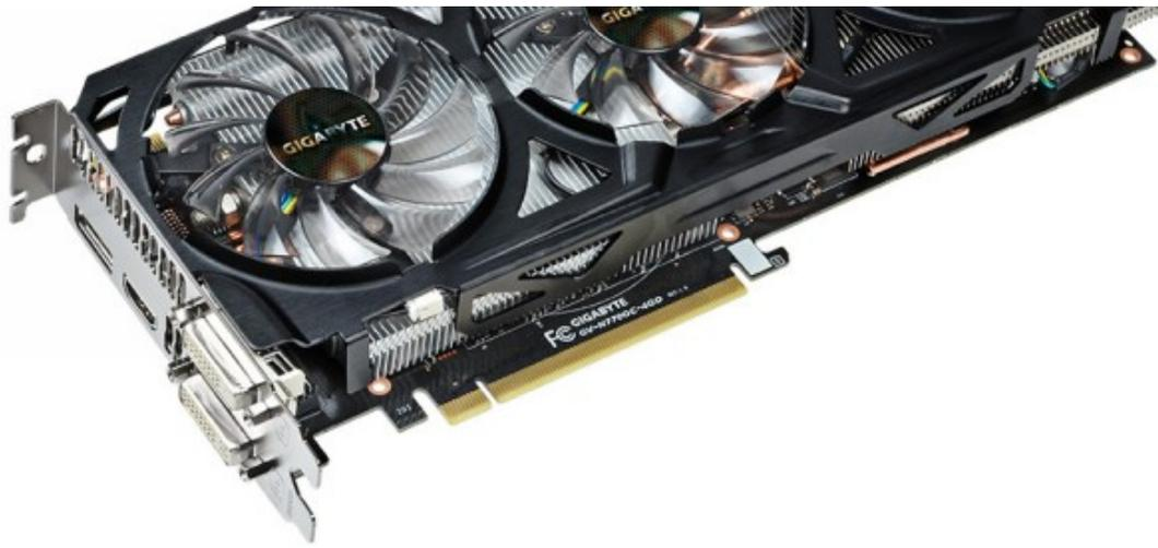
La VGA ha una ↔ velocità di clock della GPU pari a 1.137 MHz che salgono fino a 1.189 MHz in modalità GPU Boost, mentre le memorie hanno una frequenza pari a 7.010 MHz come il modello reference.
