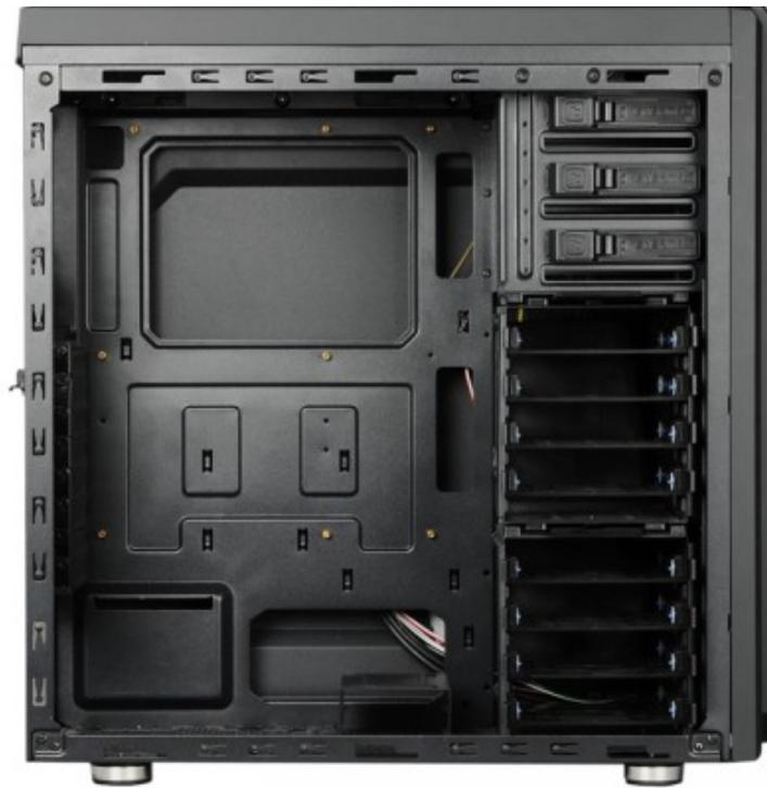
Enermax ha posto anche molta attenzione all'installazione di potenti sistemi di raffreddamento a liquido, garantendo spazio sufficiente per radiatori da 240/280mm nella parte superiore del case.
