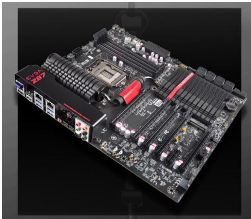
Al primo posto la Z87 Classified, ovvero il modello di punta Extended-ATX della gamma, che offre 5 slot a piena lunghezza, di cui solo 4 utilizzabili in configurazione 4x8, grazie all'uso di un chip PLX che "estende" le 16 linee per la grafica PCIe 3.0 fornite dal controller interno delle CPU Haswell.
