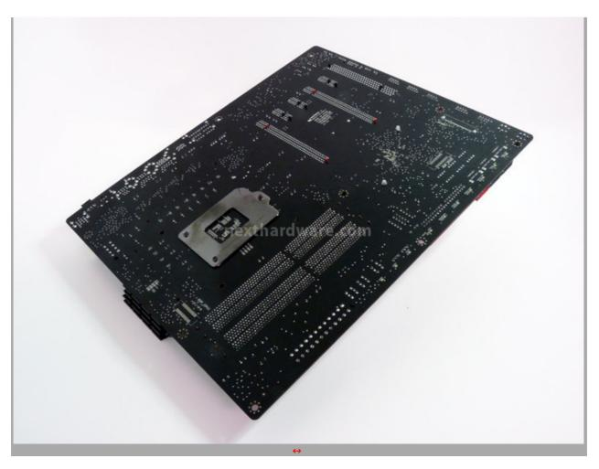
La parte sottostante del PCB appare pulita e ben organizzata e non presenta alcun componente della linea di alimentazione; i regolatori e mosfet di potenza sono posizionati solo nella parte superiore del PCB.
