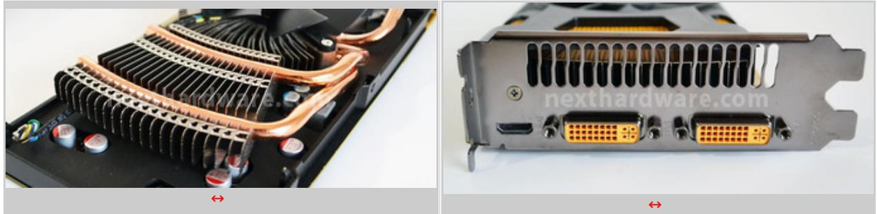
La scheda è dotata di due uscite DVI Dual Link e di una porta Mini HDMI; l'™ adattatore al connettore standard HDMI è incluso nella confezione.
