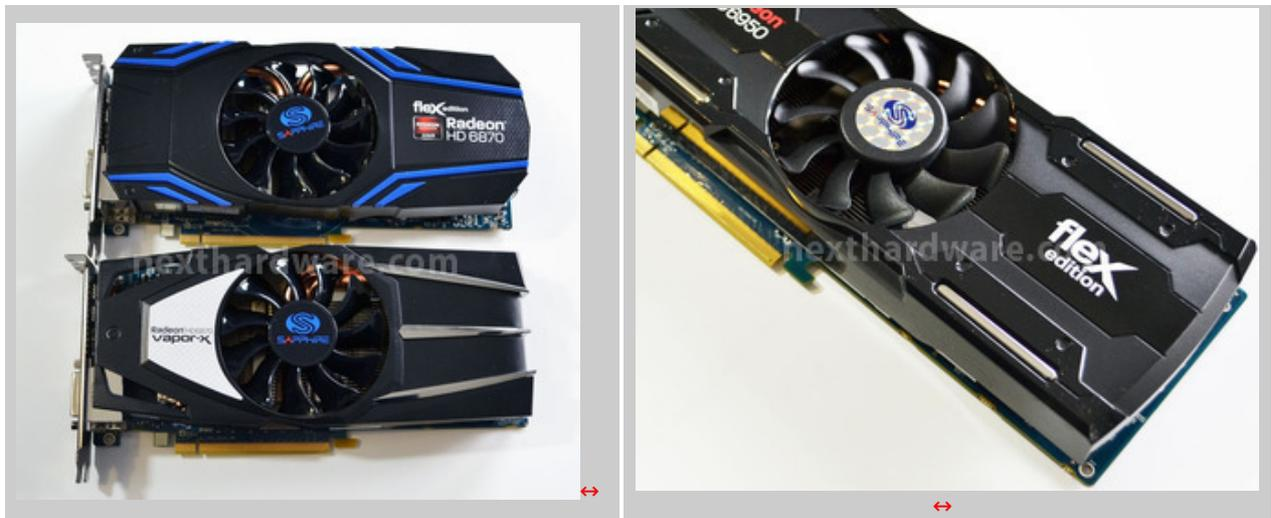
Se nei test 3D la HD 6870 Vapor-X e Flex Edition restituiscono gli stessi risultati, bisogna però sottolineare l'estrema versatilità del secondo modello che, con l'utilizzo di un adattatore HDMI-DVI (incluso), consente di collegare un terzo monitor in modalità Eyefinity senza la necessità di acquistare alcun adattatore aggiuntivo.
