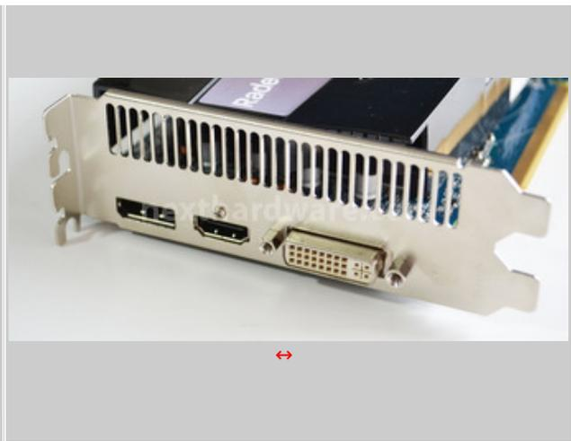
La HD 5850 Extreme supporta la tecnologia Eyefinity fino a tre schermi ed è dotata di una uscita DVI Dual Link, una Display Port 1.1 e di una HDMI 1.3; non è quindi presente il supporto alle tecnologie di visualizzazione 3D, esclusiva della serie HD 6000.
