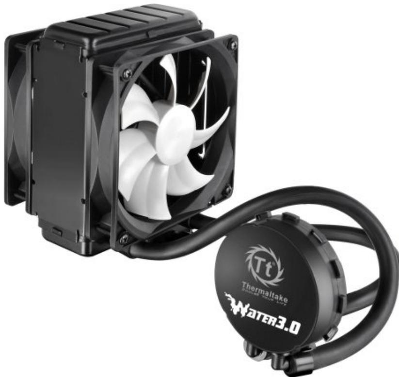
Gli altri due sistemi, denominati rispettivamente Water 3.0 Pro e Water 3.0 Performer, sono entrambi dotati di un radiatore da 120 (a doppia fila di alette per il primo e a singola fila per il secondo) di diverso spessore, raffreddati da due ventole PWM di pari caratteristiche rispetto a quelle montate sulla versione Extreme, ma montate, ovviamente, su entrambi i lati.
