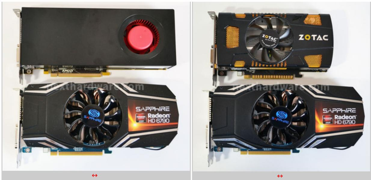
Mettendo a confronto le dimensioni della Radeon HD 6790 con quelle della GeForce GTX 550 Ti, appare subito evidente come la nuova nata di casa AMD necessiti di molto più spazio per essere installata, tuttavia, la scheda non eccede l'ingombro di una mainboard in formato Full ATX.
