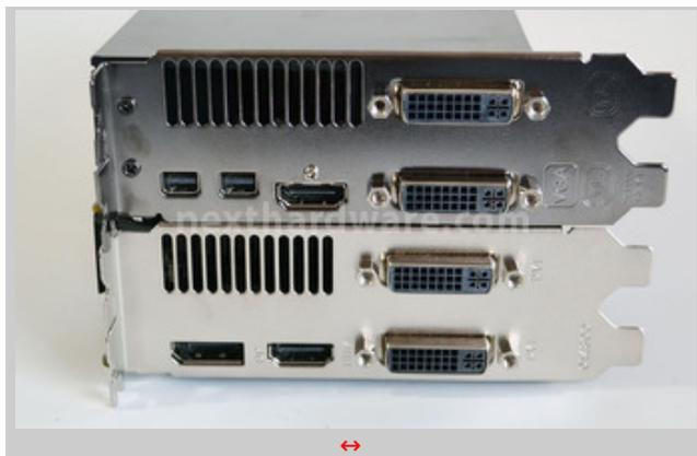
Sapphire ha scelto di dotare la sua HD 6790 di una differente configurazione di porte rispetto a quanto previsto da AMD.
