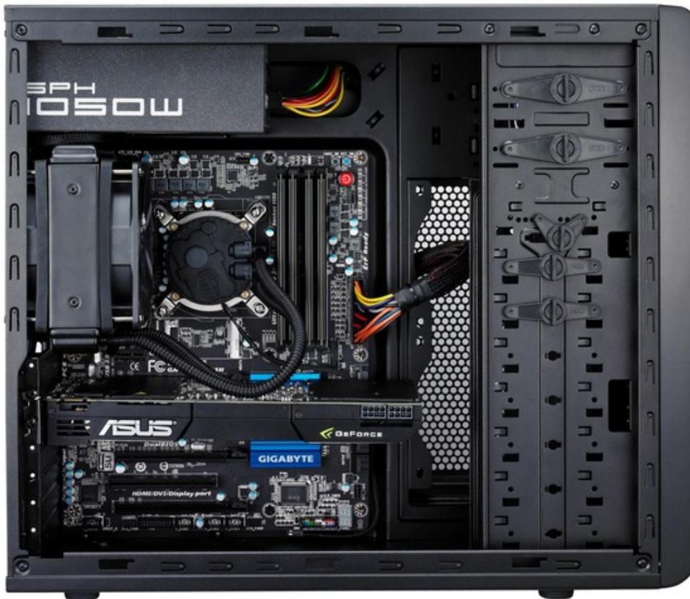
L'interio completamente verniciato in nero, una porta USB 3.0 per il trasferimento ultra rapido dei dati, la possibilità di accogliere configurazioni high-end di ultima generazione quali impianti a liquido (supporta un radiatore da 240mm ed uno da 120mm, oppure 3 radiatori da 120mm), schede madri ATX e Micro-ATX, nonché schede video ad alte prestazioni di dimensioni generose come la GTX680, sono le caratteristiche del **CM Force 500** normalmente destinate ai modelli di classe superiore.
