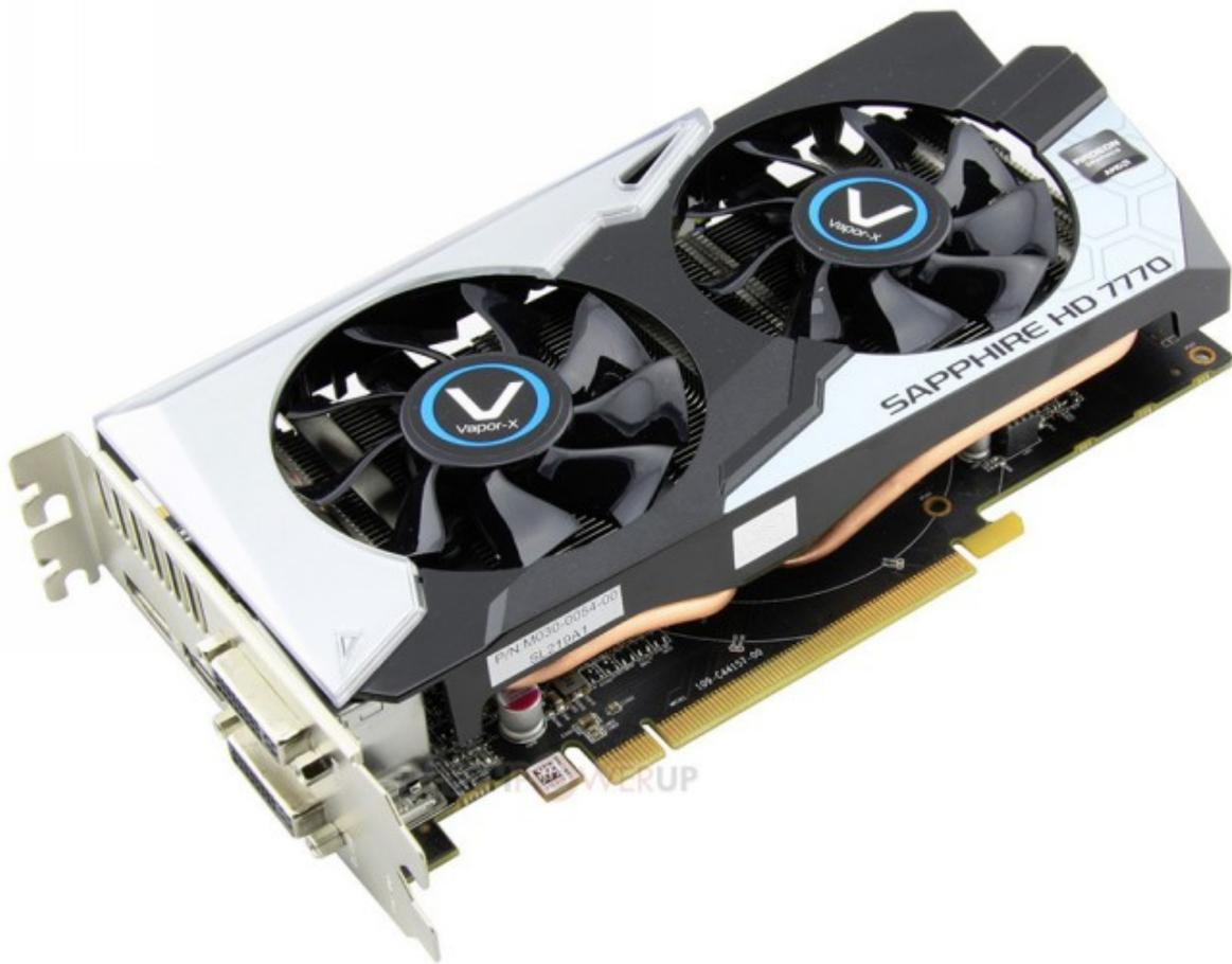
Il dispositivo di raffreddamento denominato Vapor-X, oltre alla base in rame dotata di vapor chamber, comprende due heatpipes da 8mm in rame ed un corpo dissipante realizzato con fitte alette in alluminio, il tutto raffreddato tramite due ventole da 80mm.
