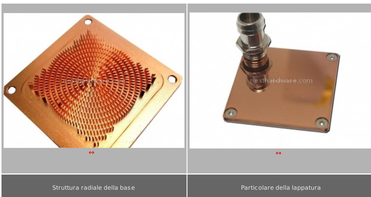
La base è costruita in rame C1100 ottenuto tramite il processo di forgiatura; è caratterizzata da una struttura radiale di micro-pin che incanalano il flusso dal centro verso il perimetro, dove passerà nella camera di raccolta superiore tramite i fori presenti nel diffusore. La lappatura della base è ottima, perfettamente a specchio come si può notare nell'immagine.
