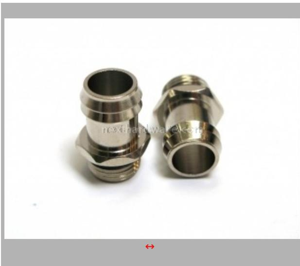
I raccordi in dotazione hanno un diametro interno di 10mm. Sono di lunghezza ridotta rispetto alla maggior parte dei raccordi in commercio ma la loro struttura garantisce un'ottima tenuta con il tubo. Sebbene Enzotech li dichiari compatibili con tubi da 1/4" ci rimane un po' difficile capire come un tubo con ID 6mm possa calzare su questo raccordo. Mal di poco dato che difficilmente si usano tubi con ID minore di 9mm.
